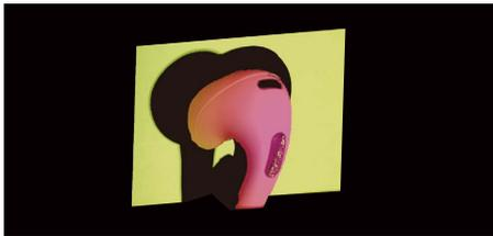
耳机外观缝隙检测点云
